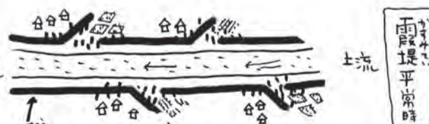
※① 堤防が開いている。田々畑や竹林になっている。
