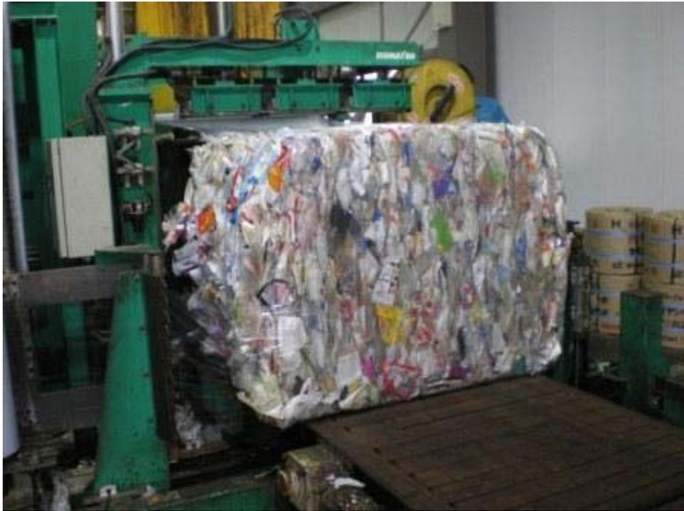
写真5 その他プラスチックが圧縮され、梱包されている時の様子（バール化）
