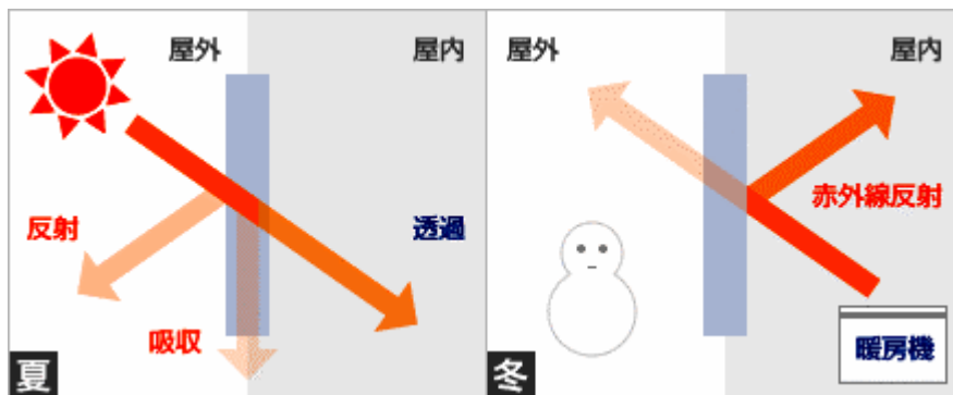
3-46 断熱フィルムの効果フロー図 6) http://www.epoc.gr.jp/syoene/technology_3.html 参照
