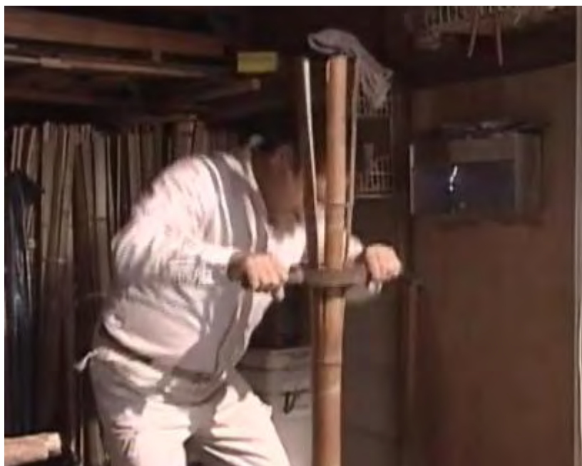
図 1-7 乾燥した竹を割る作業 19)
